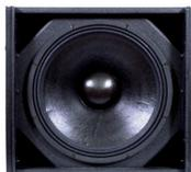
LA4 Sub - Caisson de graves, complément de l'enceinte LA4, boomer diamètre 38cm à aimant néodyme, puissance admissible 1000W, impédance 8 Ohms, poids 32Kg
